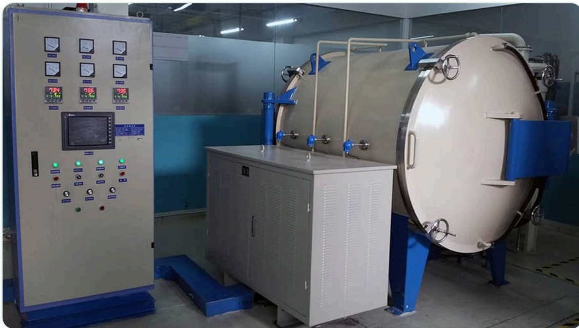
图：远航 工业炉 -高真空高温碳化处理系统
