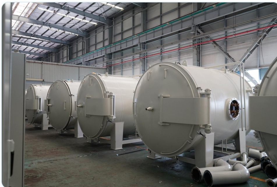
图：远航工业炉-方形卧式 石墨化炉 （解决方形物料装载难题）
