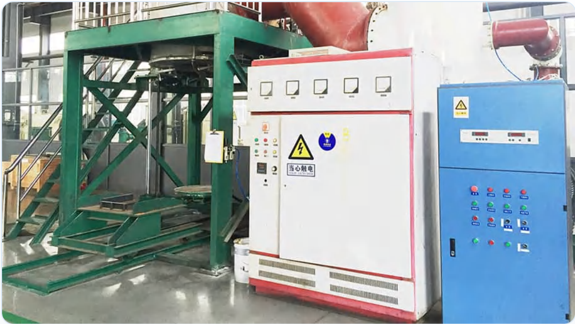
图：远航 工业炉 -真空中频感应 烧结炉 （中试/量产型）
