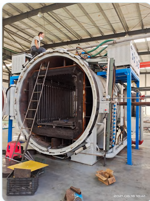
图：远航工业炉-单室卧式真空回火炉
